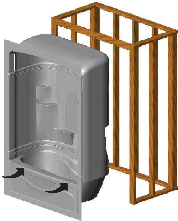
ILLUSTRATION 3 - POSITIONNER L'UNITÉ DEVANT L'ENCADREMENT
